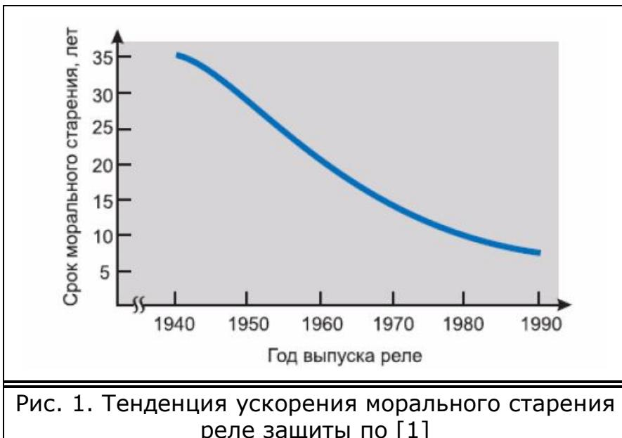
Рис. 1. Тенденция ускорения морального старения реле защиты по [1]
